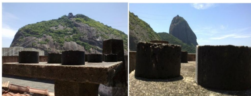
Figura 2: Corpos de prova submetidos ao envelhecimento simulado.
